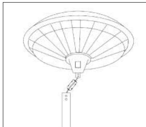
**Pasul 7:** Acum, amplasați „capul” radiatorului pe/în suportul superior, astfel încât micile orificii pentru șuruburi de sub capul radiatorului să ajungă exact peste orificiile pentru șuruburi de pe partea superioară a suportului superior. Fixați capul și suportul cu șuruburi de 2x8 mm. Cablul electric și conectorul sunt acum în modul standard.
