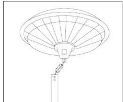
**Schritt 7:** Setzen Sie den Kopfteil des Strahlers auf das obere Rohrstück. Achten Sie dabei darauf, dass die kleinen Schraublöcher der Aufnahme am Heizkopf und die Löcher im oberen Rohrstück aufeinander liegen. Schrauben Sie den Heizkopf mit 2x8 mm Schrauben am Standrohr fest. Das Netzkabel und der -anschluss befinden sich jetzt im Standrohr.
