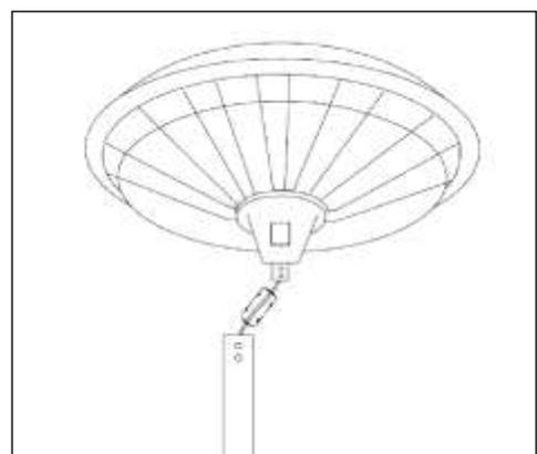
**Stap 7:** Plaats nu het 'hoofd' van de straler zodanig op/in de bovenste standaard, dat de kleine schroefgaatjes onderaan het stralerhoofd recht over de schroefgaatjes bovenin de bovenste standaard vallen en schroef hoofd en standaard aan elkaar vast met 2x8mm schroefjes. De elektrokabel en –aansluiting bevinden zich nu ín de standaard.
