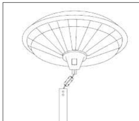
**Étape 7 :** Placez à présent la « tête » du chauffage de terrasse sur/dans le support supérieur de façon à ce que les petits trous filetés sous la tête coïncident avec les petits trous filetés en haut du support supérieur. Vissez ensuite la tête et le support avec des vis 2x8 mm. Le cordon d'alimentation et la connexion électrique se trouvent à présent dans le support.
