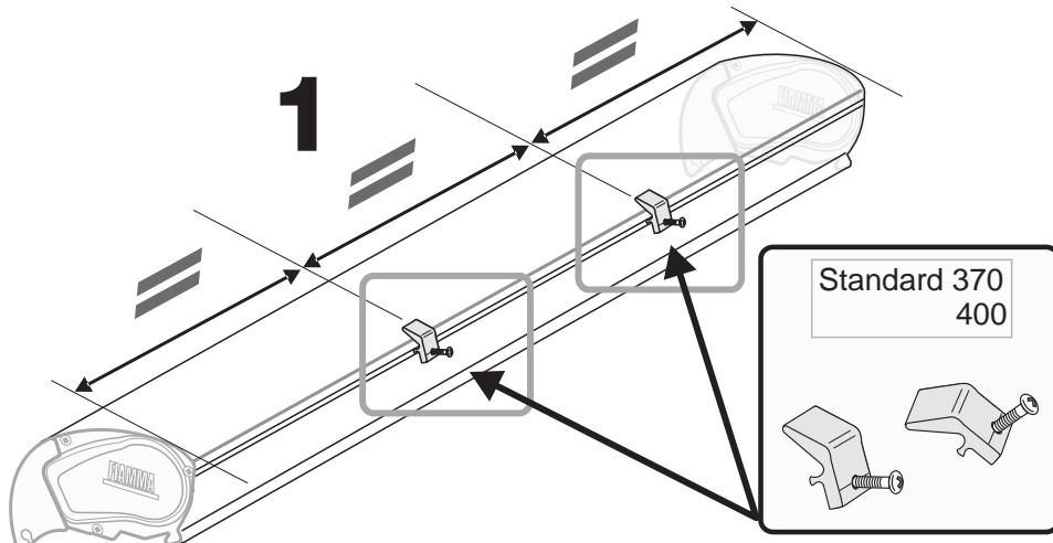
**DE** Fügen Sie den Blockierungskit des Gehäusedeckels ein und vergewissern Sie sich, dass dieser eingerastet ist. Anschließend die Schraube anziehen (eventuell ist ein leichter Druck beim Einfügen des Kit erforderlich).
