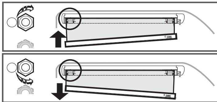
**DE** Sich vergewissern, dass sich die Frontleiste der Markise beim Auskurbeln in waagerechter Stellung befindet.
